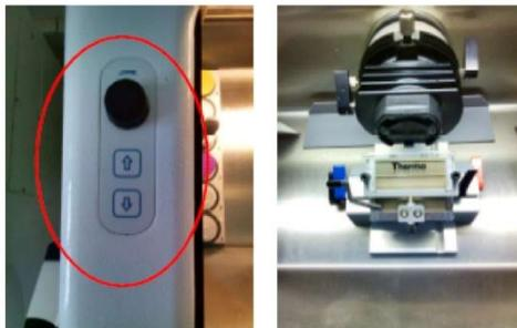
6)、装样机前进倒退按钮。黑色转钮调节样品头前进步幅。
