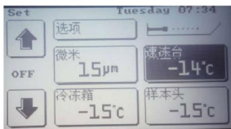
2)、点击“**速冻台**”按钮，按“**向下箭头**”打开速冻台，可根据实验经验要求调节冻台温度。也可通过长按“**选项**”按钮进入菜单界面，选择速冻台启用（系统默认 -20℃），**若需要加速冷冻样品**，长按“**速冻台**”按钮或在“选项”菜单里点击“**速冻台加速**”，速冻台按钮左下角将出现“雪花”样图标。
