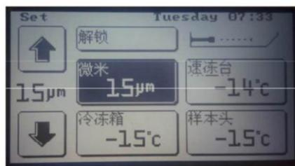
1)、本机无需关闭电源，点击屏幕，如图所示，若有“解锁”字样时，**严禁推拉玻璃挡板！**
