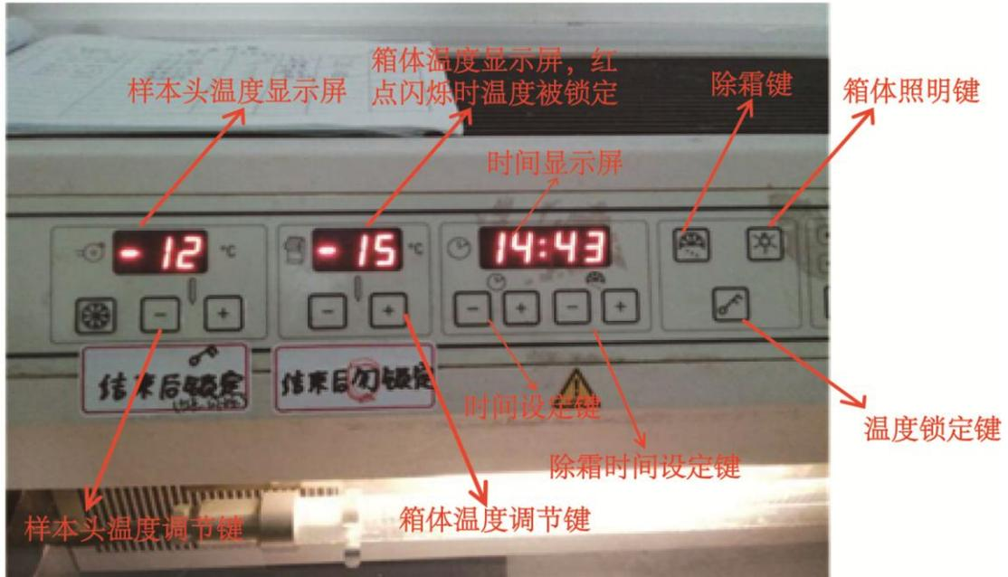
**备注:** 切片机使用结束后, 收拾清理箱体, 锁定样本头温度, 不可锁定箱体温度。
