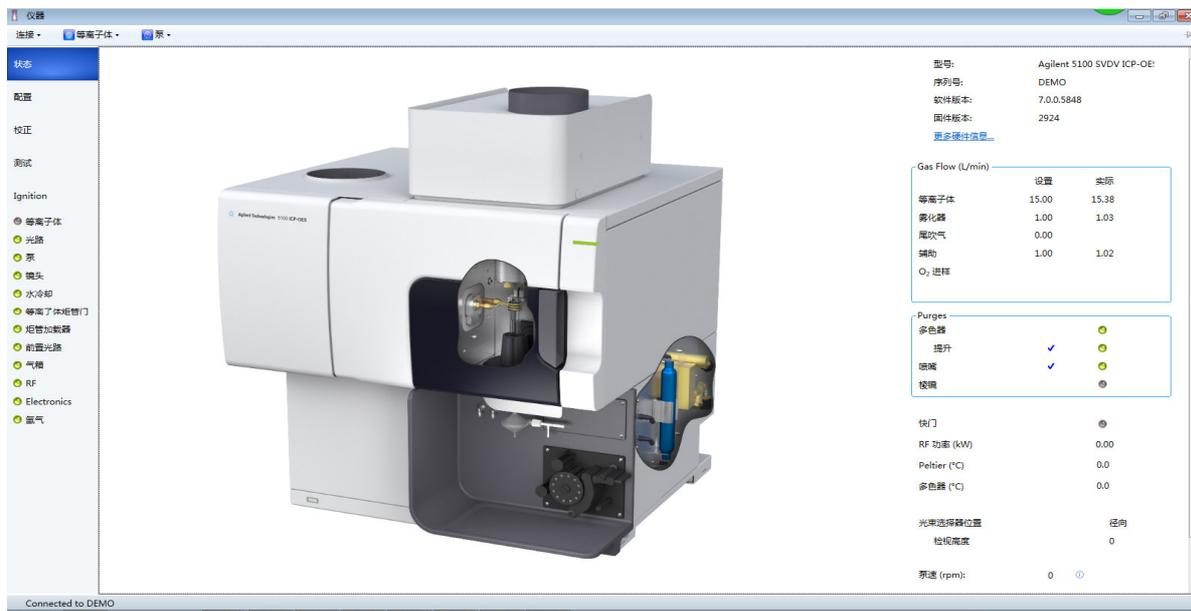
6、选择 **连接**，检查仪器是否处于联机状态，仪器联机时右前方 LED 指示灯显示为绿色。
